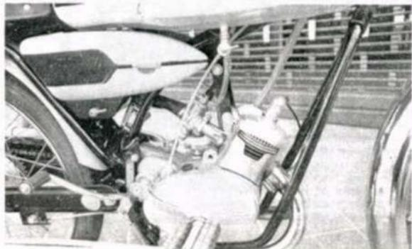
Côté face on remarque la turbine de refroidissement et l'attache supérieure du moteur. Le symétrique du coffre à outils renferme un volumineux silencieux d'admission.
