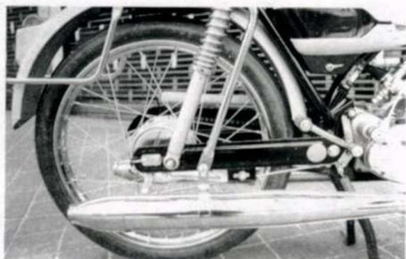
Si le cadre est tubulaire, le bras oscillant est par contre en tôle emboutie. On peut distinguer en outre le bouchon en caoutchouc dont il est question dans le texte.
