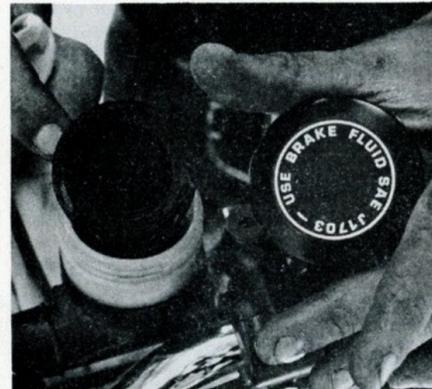
L'étanchéité du réservoir de lockheed est garantie par ce joint caoutchouc pas toujours efficace. Il permet principalement d'éviter l'oxydation du lockheed au contact de l'air.
