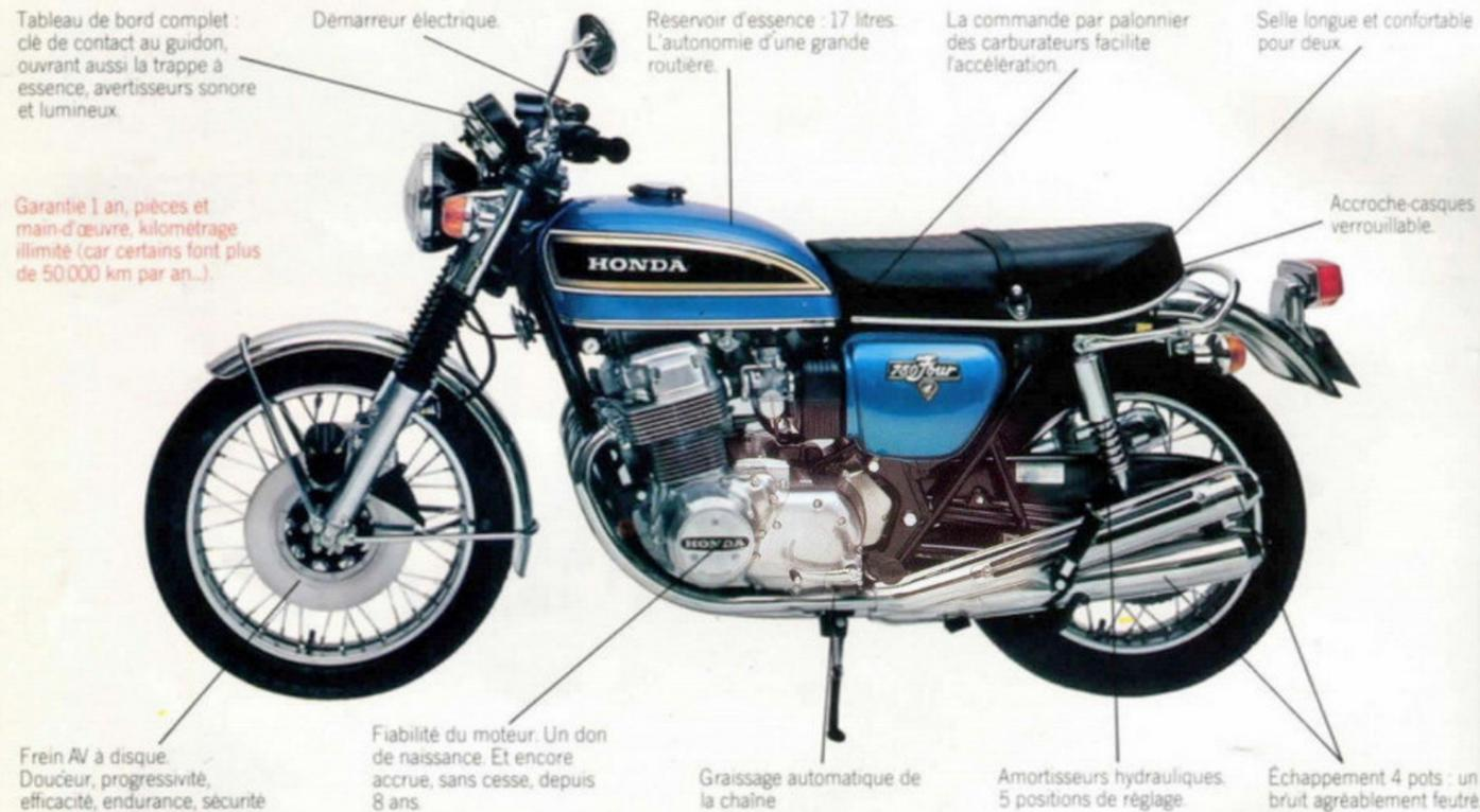
Tableau de bord complet : clé de contact au guidon, ouvrant aussi la trappe à essence, avertisseurs sonore et lumineux.
