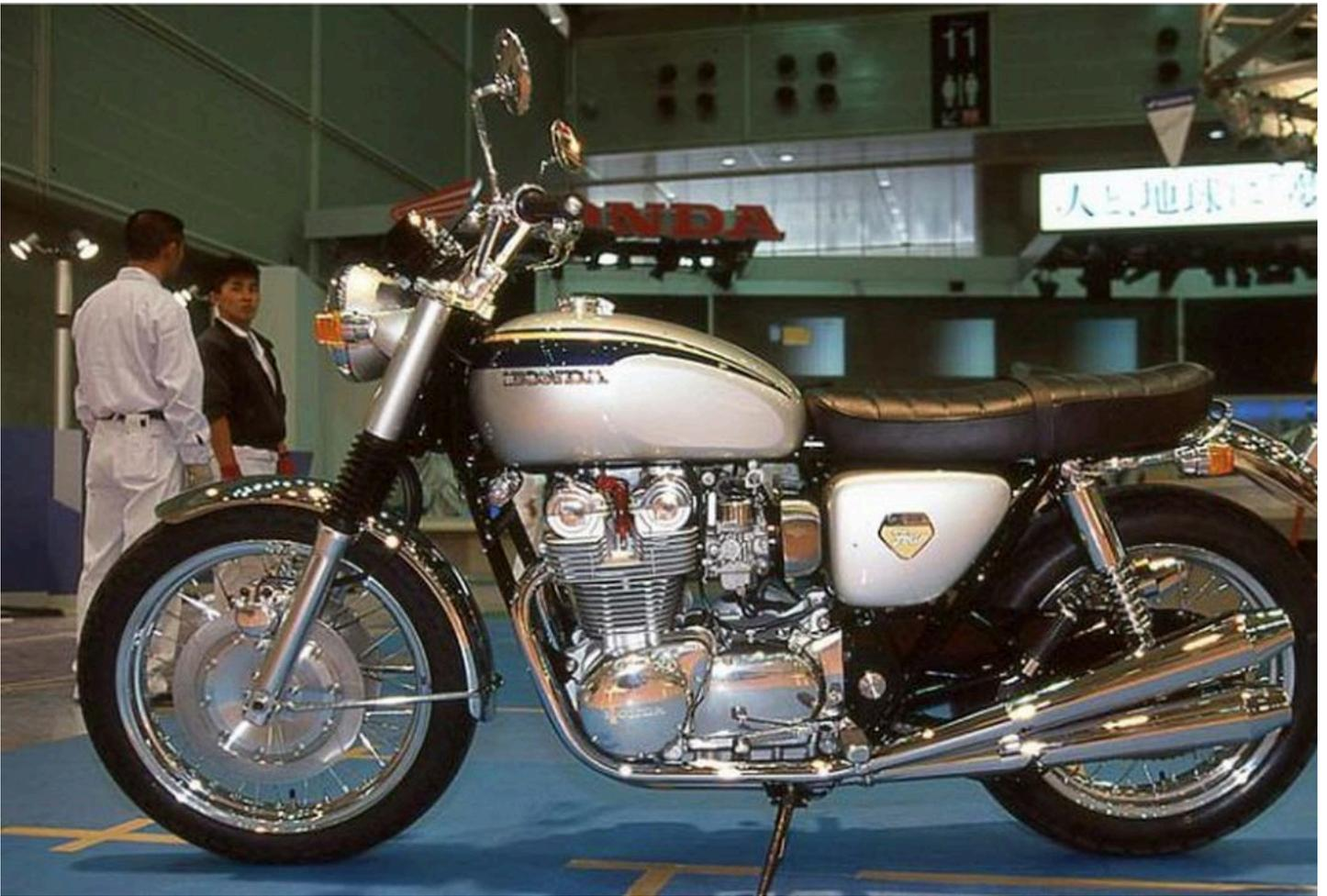
La [Honda CB750 F](#) de 1999 portait des pneus Dunlop TT100GP dans les tailles 100/90-19 et 130/80-18, tandis que le bras oscillant (qui était recouvert par les deux échappements de chaque côté) était constitué de tubes en acier. Les deux **amortisseurs arrière** étaient également une copie de ceux de la moto d'origine, tout comme les garde-boue chromées.
