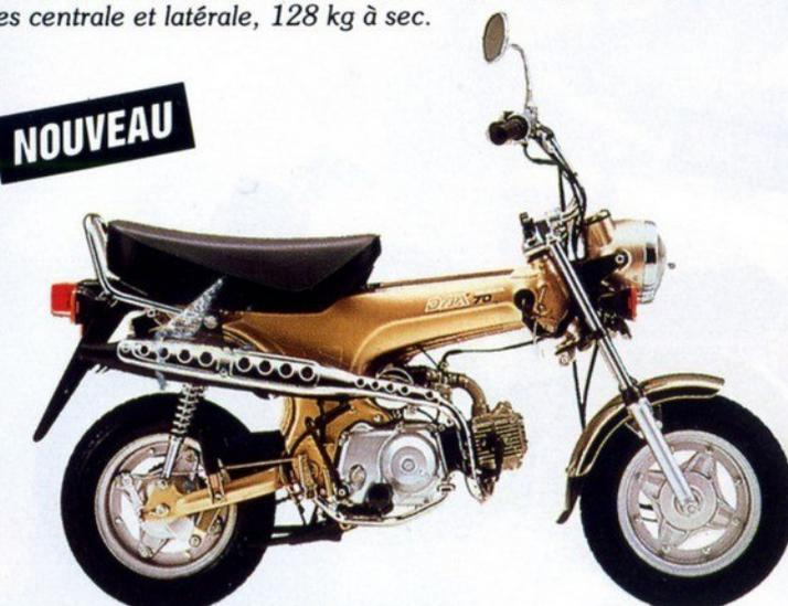
**ST 70 DAX:** monocylindre 4 temps, 1 ACT - 2 soupapes, 3 rapports semi-automatiques, 4,8 ch à 8.000 tr/mn, réservoir 2,5 litres, tambours AV et AR, selle biplace et guidon repliable, 73 kg à sec.
