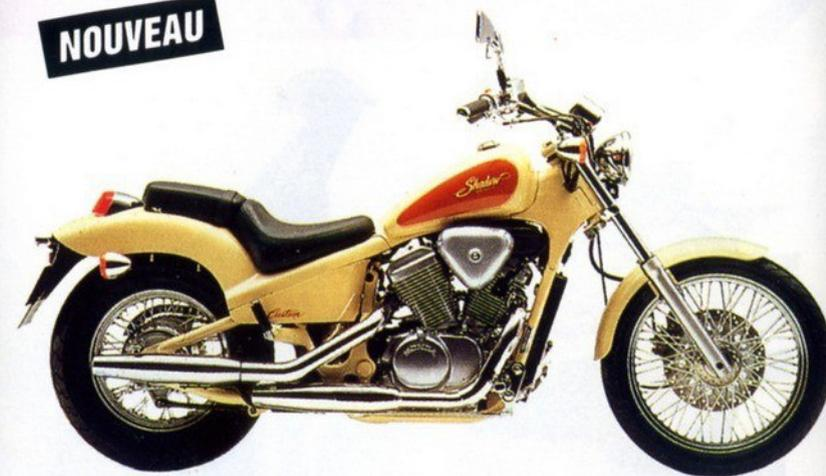
**VT 600 C SHADOW:** bicylindre en V 4 temps, 1 ACT - 3 soupapes par cylindre, refroidissement liquide, 4 rapports, démarreur électrique, 41 ch à 6.500 tr/mn - 5,25 kgm dès 3.500 tr/mn, réservoir 9 litres, disque AV - tambour AR, 196 kg à sec.
