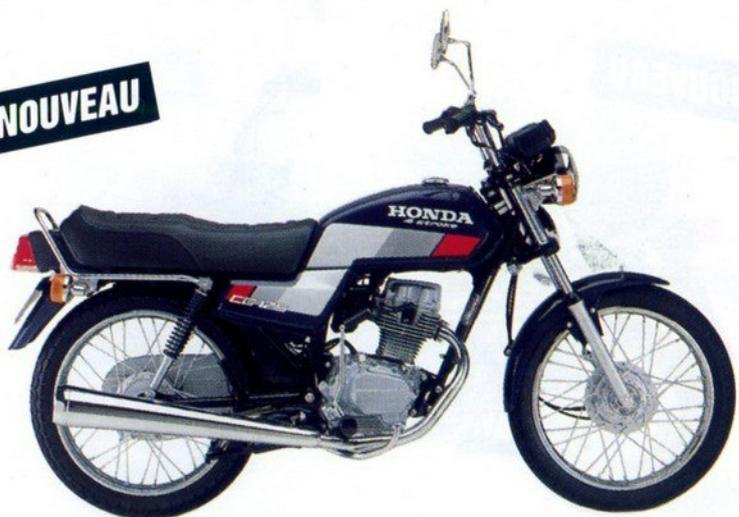
**CG 125:** monocylindre 4 temps, 2 soupapes, 5 rapports, 11 ch à 8.500 tr/mn, réservoir 12 litres, tambours AV et AR, selle biplace, béquille centrale, 105 kg à sec.
