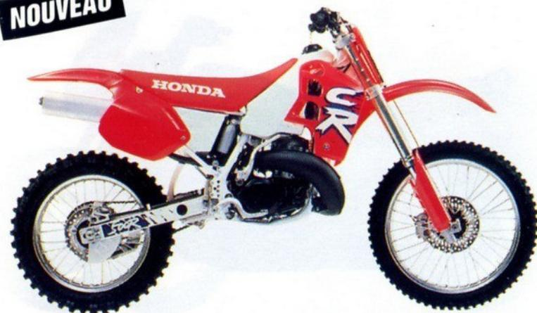
**CR 500 R:** monocylindre 2 temps, refroidissement liquide, 64 ch à 6.000 tr/mn. - 7,4 kgm à 6.000 tr/mn, 5 rapports, réservoir 9 litres, fourche inversée  $\varnothing$ 43 mm et 309 mm de débattement, 320 mm de débattement AR, freins à disque AV et AR, 101 kg à sec, assurance CADRE-ROUGE comprise dans le prix de vente.
