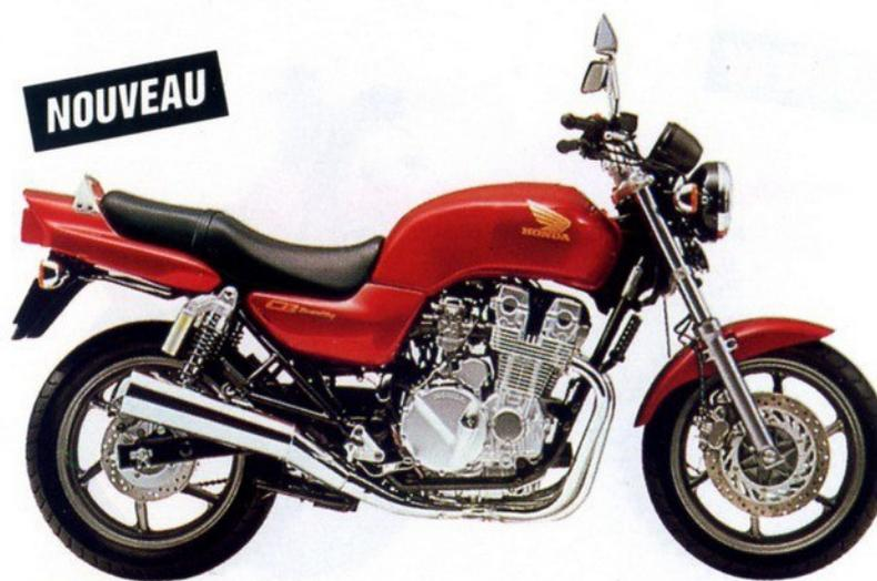
**CB 750 SEVEN FIFTY:** 4 cylindres en ligne, 4 temps, 2 ACT - 16 soupapes, refroidissement par air, 5 rapports, démarreur électrique, 74 ch à 8.500 tr/mn. 6,4 kgm à 7.500 tr/mn, réservoir 20 litres, transmission par chaîne à joints toriques, double disque AV - simple AR - béquilles centrale et latérale, 214 kg à sec.
