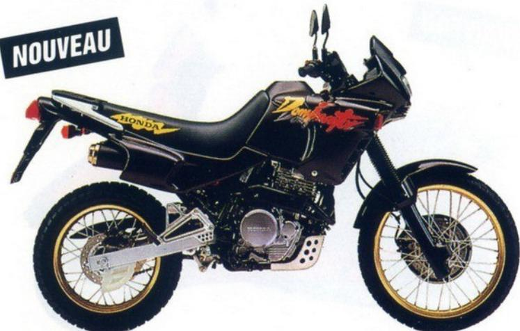
**NX 650 DOMINATOR:** monocylindre 4 temps, 1 ACT, 4 soupapes, 5 rapports, démarreur électrique, 46 ch à 6.000 tr/mn, 5,8 kgm à 5.000 tr/mn, réservoir 16 litres, disques AV et AR, carénage "tête de fourche", 163,6 kg à sec.
