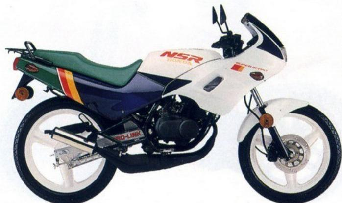
**NSR 50:** monocylindre 2 temps, refroidissement par air, graissage séparé, réservoir 10 litres, transmission V-MATIC, disque AV - tambour AR, carénage "tête de fourche", 92 kg à sec.
