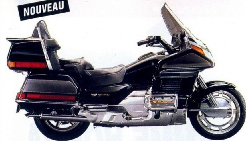
**GL 1500 GOLDWING SE:** 6 cylindres à plat (flat 6) 4 temps, 1 ACT - 2 soupapes par cylindre, refroidissement liquide, 4 rapports + 1 surmultiplié, démarreur électrique, 100 ch à 5.000 tr/mn. - 15,3 kgm dès 4.000 tr/mn, réservoir 24 litres, transmission par cardan, double disque AV - simple AR, suspension AR réglable à distance, équipement radio intégré, béquilles centrale et latérale, 368 kg à sec.
