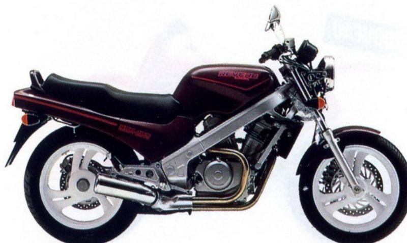
**NTV 650 REVERE:** bicylindre en V 4 temps, 1 ACT - 3 soupapes par cylindre, refroidissement liquide, 5 rapports, démarreur électrique, 57 ch à 7.500 tr/mn - 5,7 kgm à 6.500 tr/mn, réservoir 19 litres, transmission par cardan, monobras oscillant AR, disques AV et AR, béquilles centrale et latérale, 191 kg à sec.
