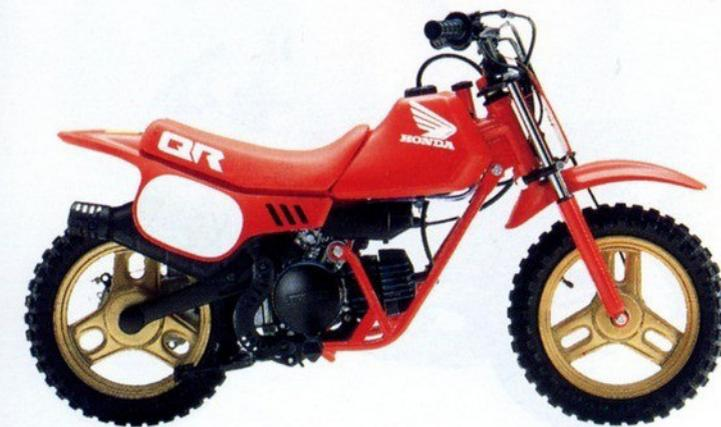
**QR 50:** monocylindre 2 temps, graissage séparé, refroidissement par air, réservoir 2 litres, embrayage automatique, fourche télescopique, mono-bras AR, 35 kg à sec, assurance CADRE-ROUGE comprise dans le prix de vente.
