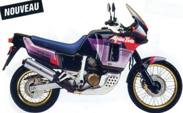
**XR750 AFRICA TWIN:** bicylindre en V 4 temps, 1 ACT - 3 soupapes par cylindre, refroidissement liquide, 5 rapports, démarreur électrique, trip-master électronique, 59 ch à 7.500 tr/mn - 6,1 kgm à 5.500 tr/mn, réservoir 24 litres, double disque AV - simple AR, carénage "tête de fourche" avec double optique, béquilles centrale et latérale, 210 kg à sec.
