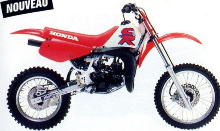
**CR 80 R:** monocylindre 2 temps, refroidissement liquide, 26,2 ch à 12.000 tr/mn, 1,53 kgm à 11.500 tr/mn, 6 rapports, réservoir 5 litres, fourche de  $\varnothing$ 35 mm et 275 mm de débattement PRO-LINK, 280 mm de débattement AR, freins à disque AV/AR, 63 kg à sec, assurance CADRE-ROUGE comprise dans le prix de vente.
