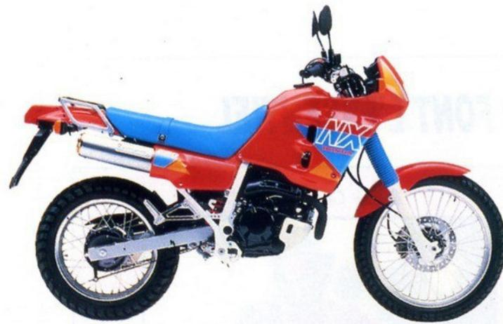
**NX 250:** monocylindre 4 temps, 2 ACT - 4 soupapes, refroidissement liquide, démarreur électrique, 6 rapports, 26 ch à 8.500 tr/mn - 2,4 kgm à 7.000 tr/mn, réservoir 9 litres, disque AV - tambour AR, carénage "tête de fourche", 123 kg à sec.
