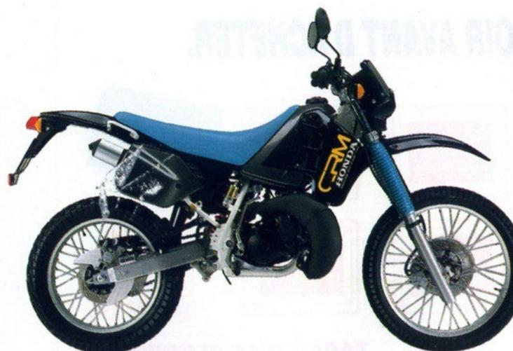
**CRM 125:** monocylindre 2 temps avec RC valves, refroidissement liquide, 6 rapports, 13 ch à 9.500 tr/mn, réservoir 9 litres, cadre avec boucle AR démontable, disques AV et AR, 118 kg à sec.
