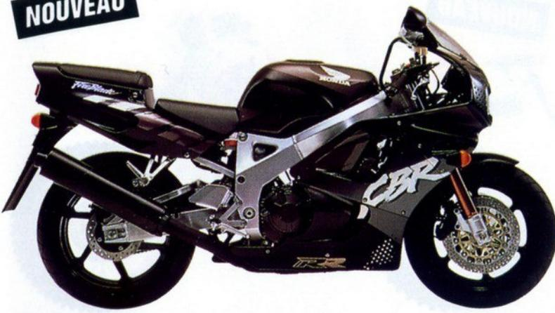
**CBR 900 RR FIREBLADE:** 4 cylindres en ligne inclinés 4 temps, 16 soupapes - 2 ACT. Refroidissement liquide - 6 rapports, démarreur électrique, 100 ch à 10.500 tr/mn - 9 kgm à 8.500 tr/mn. Réservoir 18 litres, transmission par chaîne à joints toriques. Double disque AV - simple AR. Béquille latérale. 185 kg à sec.
