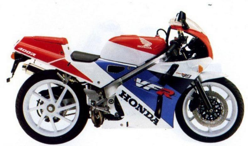
**VFR 400 R:** 4 cylindres en V, 4 temps, 2 ACT, 4 soupapes par cylindre, refroidissement liquide, cadre double poutre "Diamant" en aluminium, monobras PRO-ARM, double disque AV, simple disque AR, carénage intégral, 175 kg à sec.
