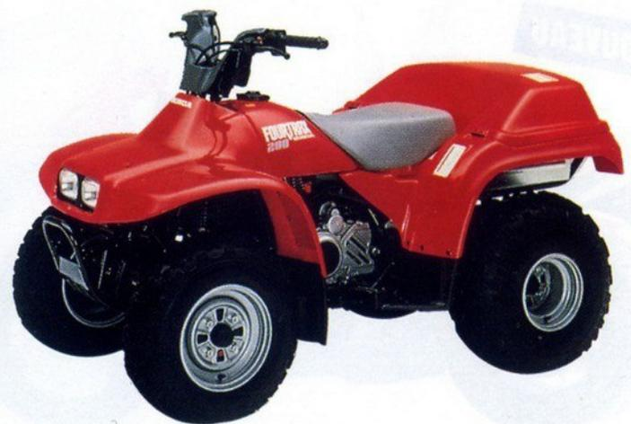
**FOURTRAX 200:** monocylindre 4 temps, refroidissement par air, démarrage électrique, 4 rapports et 1 marche arrière, transmission par chaîne sous-carter, suspensions indépendantes AV, bras oscillant AR, 3 freins tambour, réservoir 8 litres, coffre 55 litres, 186 kg à sec.
