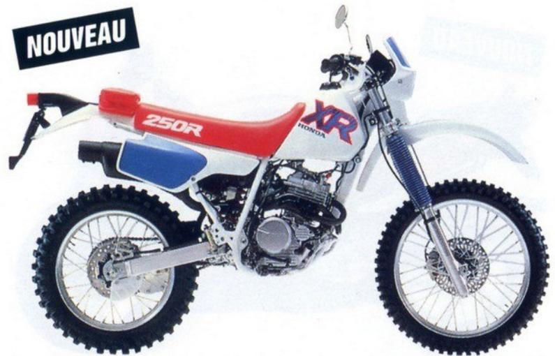
**XR 250 R:** monocylindre 4 temps, 1 ACT, 4 soupapes (culasse RFVC), 6 rapports, 26,3 ch à 8.000 tr/mn - 2,44 kgm à 7.000 tr/mn, réservoir 9 litres, fourche à cartouche réglable AV - PRO-LINK AR, disques AV et AR, 115 kg à sec.
