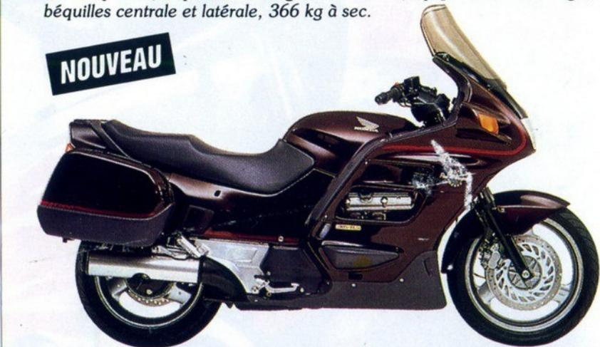
**ST 1100 PAN EUROPEAN ABS-TCS:** 4 cylindres en V - 90° 4 temps, 2 ACT - 16 soupapes, refroidissement liquide, 5 rapports, démarreur électrique, 100 ch à 7.500 tr/mn - 11,3 kgm à 6.000 tr/mn, réservoir 28 litres, transmission par cardan avec amortisseurs intégrés, double disque AV et simple AR avec système ABS, système anti-patinage (TCS), débrayable. Sacoche 35 l détachables incluses, béquilles centrale et latérale, 295 kg à sec.
