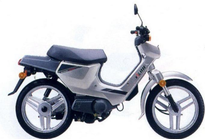
**PK 50 WALLAROO:** monocylindre 2 temps, refroidissement par air forcé, démarrage par kick, coffre sous la selle, 2,75 ch à 5.800 tr/mn, réservoir 3,3 litres, transmission V-MATIC, monobras AR, freins tambour AV et AR, béquille centrale, casque aux couleurs de la machine en option, 59 kg à sec. Démarreur électrique, clignotants et compteur uniquement sur le modèle luxe.
