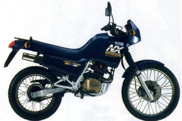
**NX 125:** monocylindre 4 temps, 1 ACT - 2 soupapes, 6 rapports, démarreur électrique, 13 ch à 9.000 tr/mn, réservoir 9 litres, disque AV - tambour AR, carénage "tête de fourche", 122 kg à sec.
