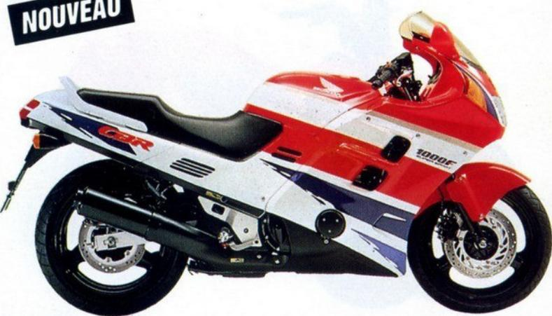
**CBR 1000 F:** 4 cylindres en ligne 4 temps, 2 ACT - 4 soupapes par cylindre, refroidissement liquide, 6 rapports, démarreur électrique, 100 ch à 9.000 tr/mn - 10,6 kgm à 8.500 tr/mn, réservoir 21 litres, cadre "Diamond", double disque AV - simple AR, carénage intégral, béquilles centrale et latérale, 230 kg à sec.
