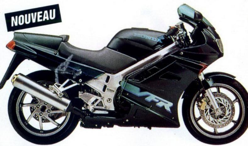
**VFR 750 F CARAT:** 4 cylindres en V 4 temps, 2 ACT - 4 soupapes par cylindre, refroidissement liquide, 6 rapports, démarreur électrique, 100 ch à 10.000 tr/mn - 7,4 kgm à 9.500 tr/mn, réservoir 19 litres, cadre double poutre aluminium, monobras PRO-ARM, double disque AV - simple AR, carénage intégral, béquilles centrale et latérale, 219 kg à sec.
