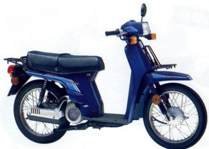
**SH 50 SCOOPY:** monocylindre 2 temps, refroidissement par air forcé, graissage séparé, réservoir 4,5 litres, transmission V-MATIC, tambours AV et AR, porte-paquets AV et AR, 68 kg à sec.
