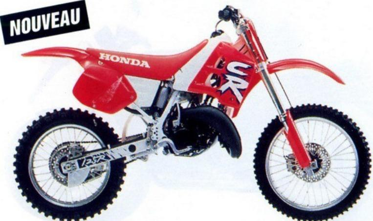
**CR 125 R:** monocylindre 2 temps, refroidissement liquide, 38,5 ch à 11.000 tr/mn, 2,51 kgm à 10.000 tr/mn, 6 rapports, réservoir 7,5 litres, fourche inversée  $\varnothing$ 43 mm et 309 mm de débattement, 320 mm de débattement AR, freins à disque AV et AR, 87 kg à sec, assurance CADRE-ROUGE comprise dans le prix de vente.
