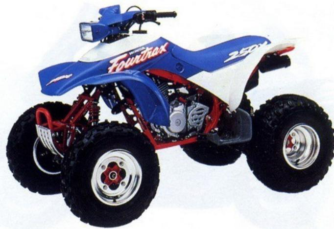
**FOURTRAX 250 X:** monocylindre 4 temps, 4 soupapes par cylindre, refroidi par air, démarrage par kick avec décompresseur, 5 rapports et une marche arrière, suspensions indépendantes AV et 170 mm de débattement, bras oscillant AR et 200 mm de débattement, 2 disques AV, simple disque AR, réservoir 8,5 litres, 164 kg à sec.
