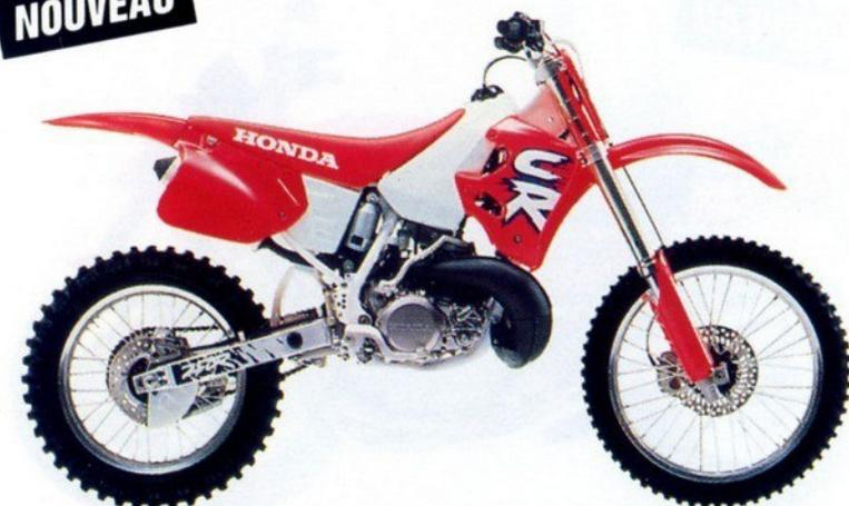
**CR 250 R:** monocylindre 2 temps, refroidissement liquide, 53,1 ch à 8.000 tr/mn, 4,97 kgm à 7.500 tr/mn, 5 rapports, réservoir 7,5 litres, fourche inversée  $\varnothing$ 43 mm et 309 mm de débattement, 320 mm de débattement AR, freins à disque AV et AR, 96,5 kg à sec, assurance CADRE-ROUGE comprise dans le prix de vente.
