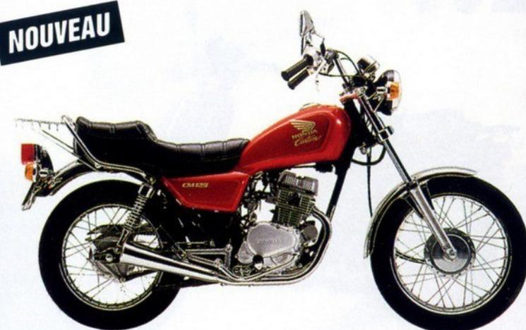
**CM 125 CUSTOM:** bicylindre en ligne, 4 temps, 1 ACT - 2 soupapes par cylindre, 5 rapports, démarreur électrique, 13 ch à 10.000 tr/mn, réservoir 12,5 litres, tambours AV et AR, selle biplace et porte-paquets AR, béquilles centrale et latérale, 128 kg à sec.
