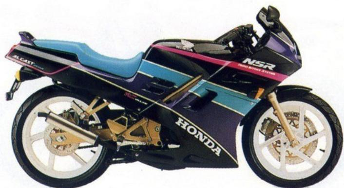
**NSR 125 R:** monocylindre 2 temps avec RC valves, refroidissement liquide, démarreur électrique, 6 rapports, 13 ch à 8.000 tr/mn, réservoir 10 litres, cadre "ALCAST" en aluminium, simple disque AV - simple AR, carénage intégral, béquilles centrale et latérale, 127 kg à sec.
