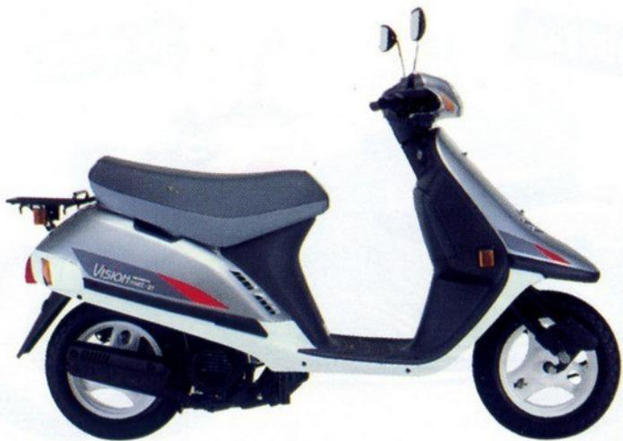
**SA 50 VISION MET IN:** monocylindre 2 temps, refroidissement par air, graissage séparé, réservoir 5,5 litres, transmission V-MATIC, démarreur électrique, tambours AV et AR, coffre intégré sous la selle, casque aux couleurs de la machine et assurance en option, 66 kg à sec.
