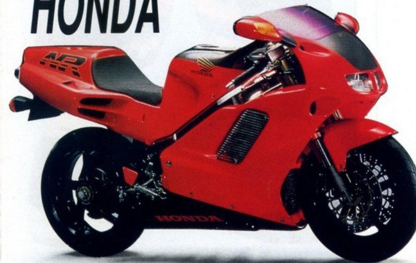
**NR 750:** 4 cylindres en V à pistons ovales, 4 temps, 8 soupapes par cylindre, injection électronique, 6 rapports, régime maxi 15.000 tr/mn, allumage transistorisé numérique, 2 bougies par cylindre. Cadre double poutre aluminium, suspension AR monobras Pro-Arm, fourche inversée diamètre 45 mm, jantes en magnésium, carénage renforcé en fibre de carbone, bulle de carénage recouverte d'un film filtrant au titane, compteur avec mémoire électronique à affichage digital.
