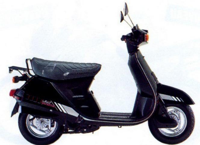
**NH 80 LEAD:** monocylindre 2 temps, refroidissement par air forcé, graissage séparé, réservoir 5,3 litres, démarreur électrique, transmission V-MATIC, tambours AV et AR, vide-poches intégré, 75 kg à sec.
