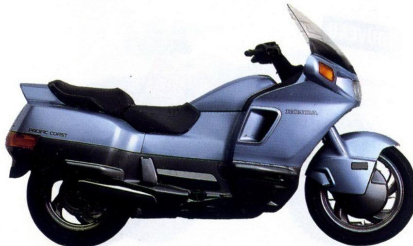
**PC 800 PACIFIC COAST:** bicylindre en V 4 temps, 1 ACT - 3 soupapes par cylindre, refroidissement liquide, 5 rapports, démarreur électrique, 60 ch à 7.000 tr/mn. - 7,5 kgm à 5.000 tr/mn, réservoir 16 litres, transmission par cardan, double disque AV - tambour AR, carénage intégral, béquilles centrale et latérale, 262 kg à sec.
