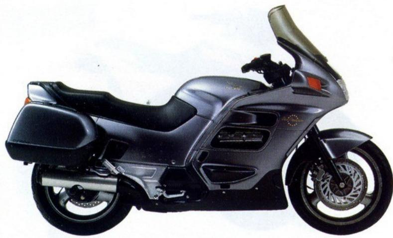
**ST 1100 PAN EUROPEAN STD:** 4 cylindres en V longitudinal 4 temps, 2 ACT - 4 soupapes par cylindre, refroidissement liquide, 4 rapports + 1 surmultiplié, démarreur électrique, 100 ch à 7.500 tr/mn - 11,2 kgm à 6.000 tr/mn, réservoir 28 litres, transmission par cardan, double disque AV - simple AR, sacoches 35 l détachables incluses, béquilles centrale et latérale, 283 kg à sec.
