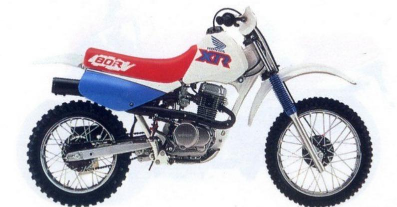
**XR 80 R:** monocylindre 4 temps, 1 ACT, refroidissement par air, 8,2 ch à 10.000 tr/mn, cadre simple berceau interrompu, fourche Ø27 mm et 140 mm de débattement, suspension AR PRO-LINK, 110 mm de débattement, freins tambour AV et AR, réservoir 6,5 litres, 64 kg à sec, assurance CADRE-ROUGE comprise dans le prix de vente.
