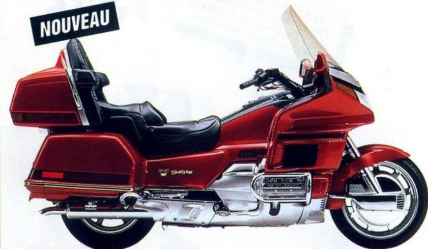
**GL 1500 GOLDWING ASPENCADE:** 6 cylindres à plat (flat 6) 4 temps, 1 ACT - 2 soupapes par cylindre, refroidissement liquide, 4 rapports + 1 surmultiplié, démarreur électrique, 100 ch à 5.000 tr/mn - 15,3 kgm dès 4.000 tr/mn, réservoir 24 litres, transmission par cardan, double disque AV - simple AR, suspension AR réglable à distance, équipement radio intégré, béquilles centrale et latérale, 366 kg à sec.
