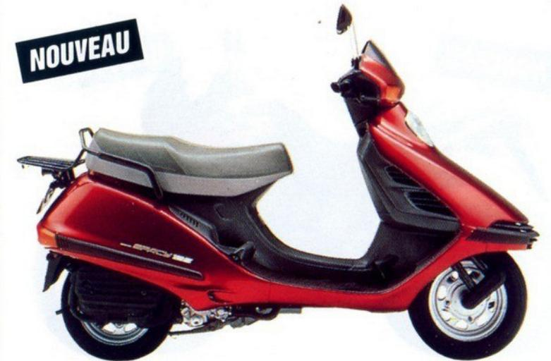
**CH 125 SPACY:** monocylindre 4 temps, refroidissement liquide, simple ACT, démarreur électrique, 9,8 ch à 8.000 tr/mn - 1,04 kgm à 6.000 tr/mn, réservoir 8 litres. Vide-poches. Freins tambour AV et AR. 118 kg à sec.
