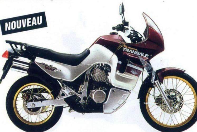
**XL 600 V TRANSALP:** bicylindre en V 4 temps, 1 ACT, 3 soupapes par cylindre, refroidissement liquide, 5 rapports, démarreur électrique, 55 ch à 8.000 tr/mn - 5,5 kgm à 6.000 tr/mn, réservoir 18 litres, disques AV et AR, carénage "tête de fourche", béquille centrale disponible en option, 183 kg à sec.
