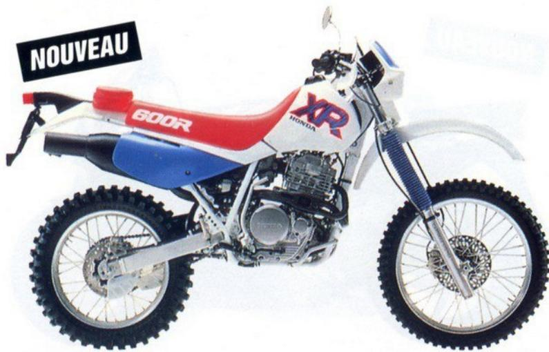
**XR 600 R:** monocylindre 4 temps, 1 ACT - 4 soupapes (culasse RFVC), 5 rapports, 46 ch à 6.500 tr/mn - 5,5 kgm à 5.000 tr/mn, réservoir 9 litres, fourche à cartouche hydraulique réglable AV - PRO-LINK AR, disques AV et AR, 128 kg à sec.
