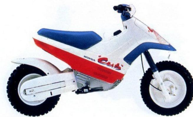
**CUB EZ 90:** monocylindre 2 temps, refroidi par air, 8,2 ch à 6.250 tr/mn, transmission V-MATIC, démarrage électrique, graissage séparé, transmission finale par chaîne sous-carter, sabot protection moteur, carénage intégral stylisé, 80 kg à sec, assurance CADRE-ROUGE comprise dans le prix de vente.
