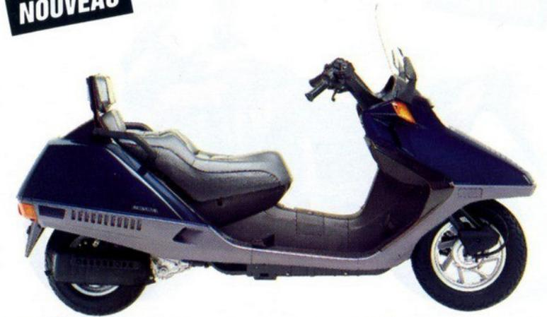
**CN 250 SPAZIO:** monocylindre 4 temps, 250 cc, refroidissement liquide, réservoir 12 litres, transmission V-MATIC, démarreur électrique, 21 ch à 7.000 tr/mn, disque AV - tambour AR, coffre AR et vide-poches AV intégrés, béquilles centrale et latérale, 156 kg à sec.
