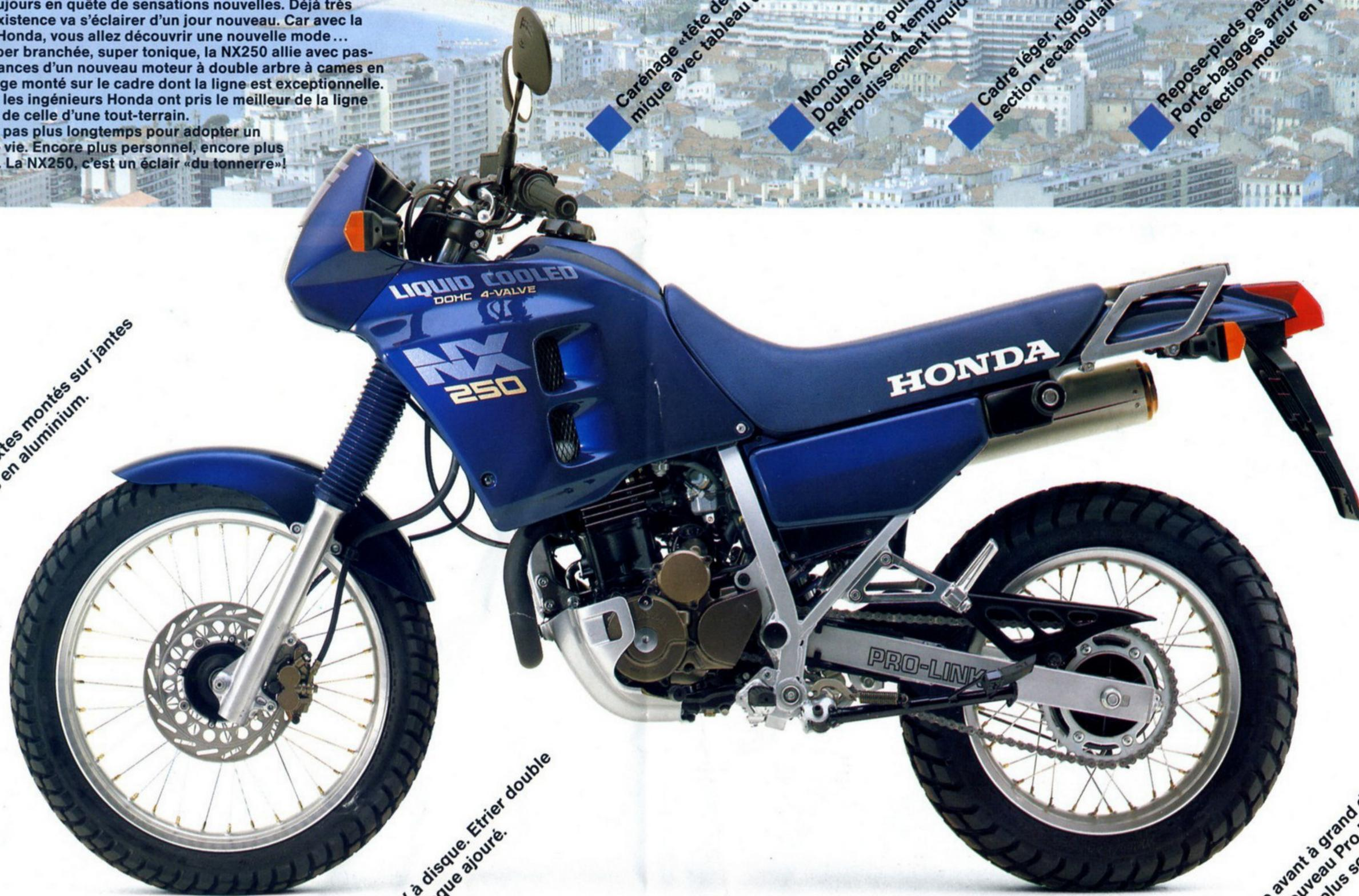
Frein AV à disque. Etrier double piston. Disque ajouré.
