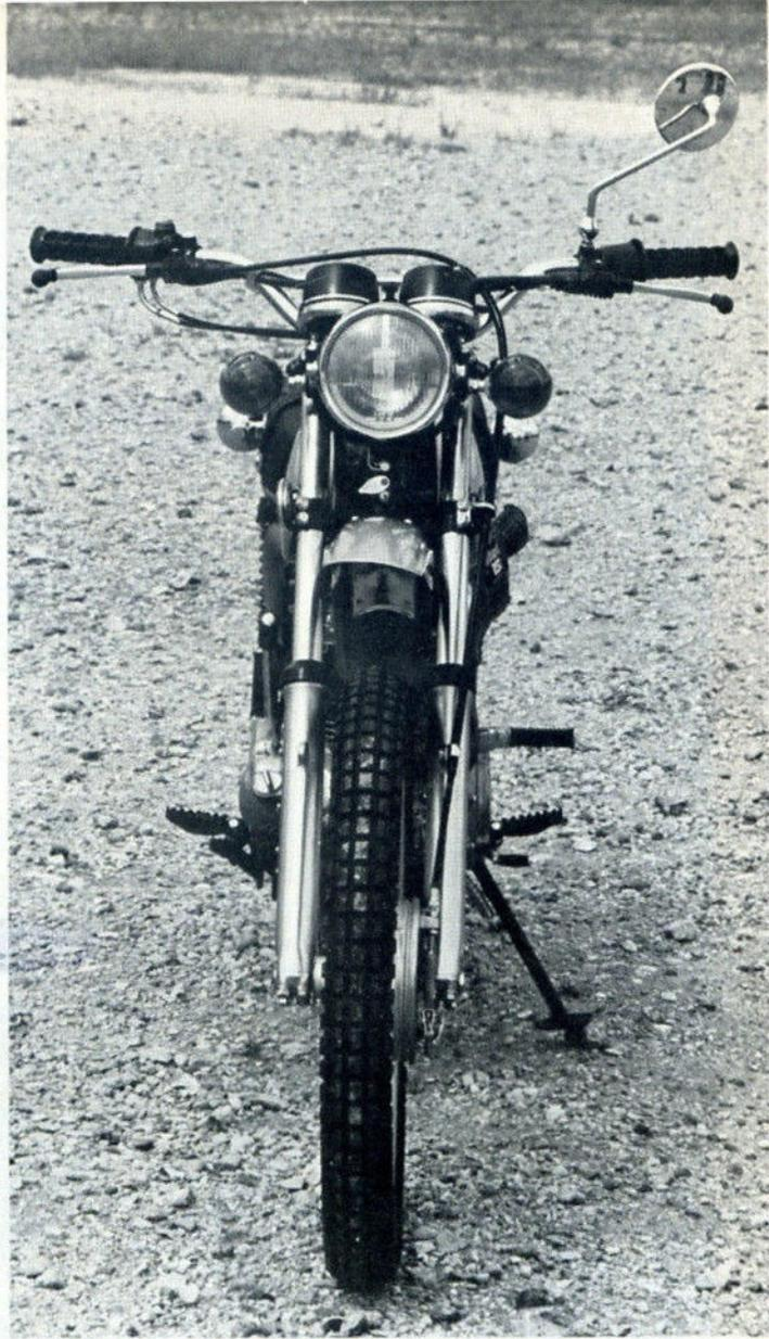
garde au sol de la machine en modifiant la position des tubes dans les potences, des repères ayant été gravés à cet effet à l'extrémité supérieure des tubes.
