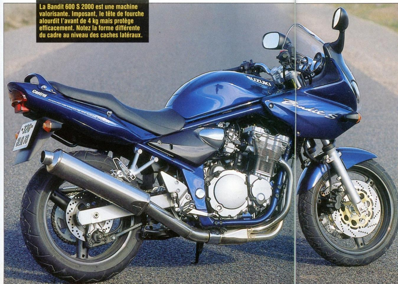
La Bandit 600 S 2000 est une machine valorisante. Imposant, le tête de fourche alourdit l'avant de 4 kg mais protège efficacement. Notez la forme différente du cadre au niveau des caches latéraux.
