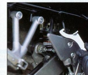
**Accessible** Grâce à une clé fournie dans la trousse à outil on peut facilement régler la précontrainte de l'amortisseur arrière (réglages d'origine : précontrainte 4, détente 2). Pratique pour le duo.
