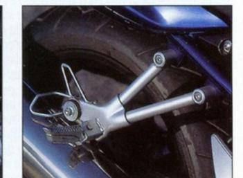
**Mieux** Les repose-pied passager ne sont plus soudés mais boulonnés au cadre. En cas de chute, ça évite d'avoir à détordre voire à changer le cadre. Les nouvelles pattes de fixation permettent d'accrocher des tendeurs.
