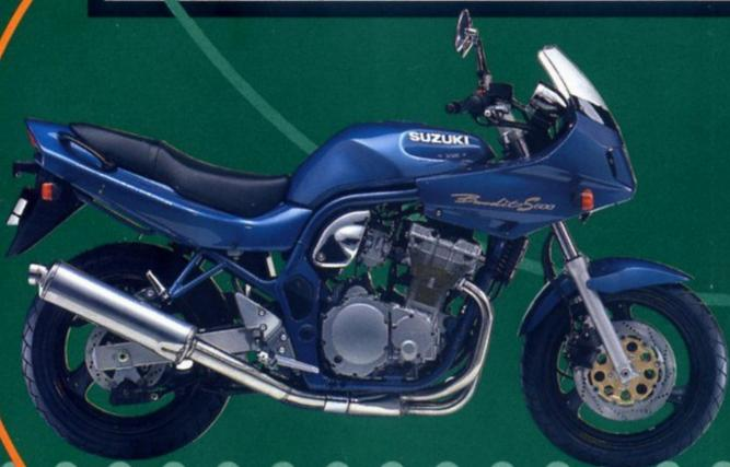
Equipée de son carénage tête de fourche, la Bandit 600 S devient une véritable routière - avec le caractère en plus ! Bien protégé, vous pourrez alors exploiter le potentiel d'une partie-cycle très équilibrée : mono-amortisseur progressif, fourche télescopique maousse, cadre double berceau ultra-rigide, etc. Partir en vacances avec copine et bagages ? Pas de problème, la Bandit 600 S est conçue pour.
