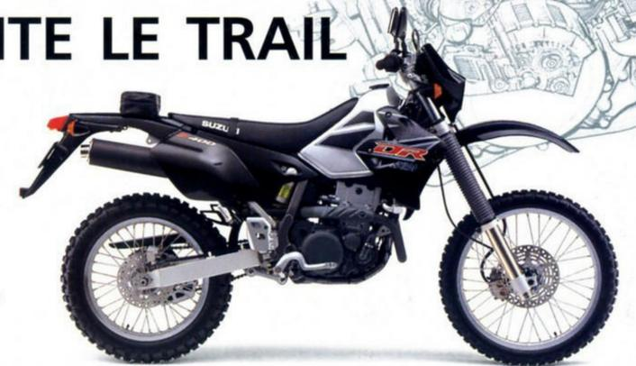
d'une solide fourche hydraulique de 49 mm à l'avant; réglable en précharge et compression (voir fiche technique) et d'un monoamortisseur réglable également en précharge et compression, avec un bras oscillant en aluminium à l'arrière. Le freinage est confié à deux simples disques, 250 mm et étrier double piston devant, 220 mm et étrier simple piston à l'arrière.
