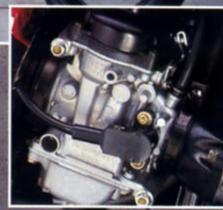
Rampe de carburateur à gestion électronique pour encore plus d'agrément.
