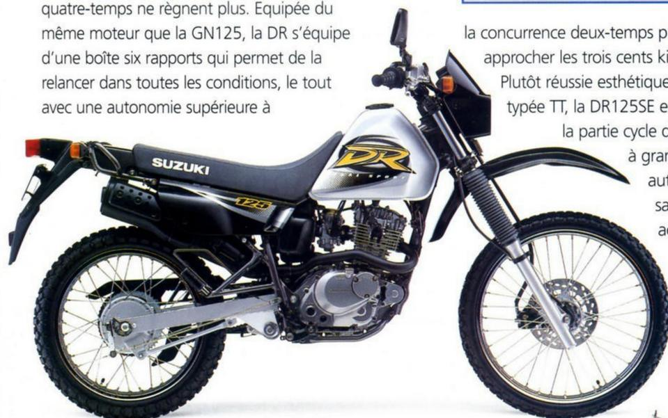
**Monocylindre • 4 temps • Refroidissement par air • 8,83 kW (12 ch) à 9 500 tr/min • Démarreur électrique • Boîte 6 rapports • Disque avant ø 230 mm • Tambour arrière ø 130 mm • Poids à sec : 114 kg • Coloris : noir / argent, bleu / blanc • Accessible permis auto.**
