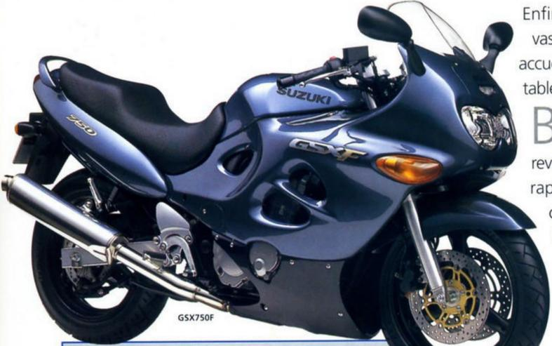
**4 cylindres** • **4 temps** • **16 soupapes** • Refroidissement mixte air/huile • **68,1 kW** (92,5 ch) à **10 500 tr/min** • Boîte **6 rapports** • Cadre double berceau tubulaire en acier • Double disque avant ø **290 mm** • Disque arrière ø **240 mm** • Poids à sec : **211 kg** • Coloris : bleu, noir.
