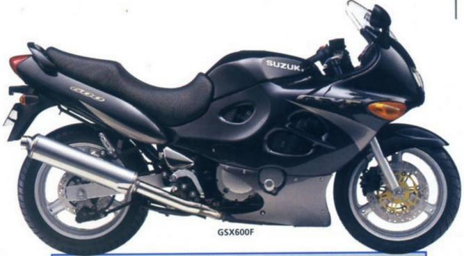
**4 cylindres** • **4 temps** • **16 soupapes** • Refroidissement mixte air/huile • **58,7 kW** (79,8 ch) à **10 500 tr/min** • Boîte **6 rapports** • Cadre double berceau en acier • Double disque avant ø **290 mm** • Disque arrière ø **240 mm** • Poids à sec : **208 kg** • Coloris : bleu, noir.
