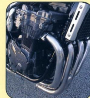
Le quatre cylindres 750, issu des fameuses Réplia de la marque, les Suzuki 750 GSX-R, est alimenté par quatre carburateurs de 32 mm. Les diagrammes de distribution sont par ailleurs tout à fait adaptés à une utilisation routière pour ce roadster au long cours.
